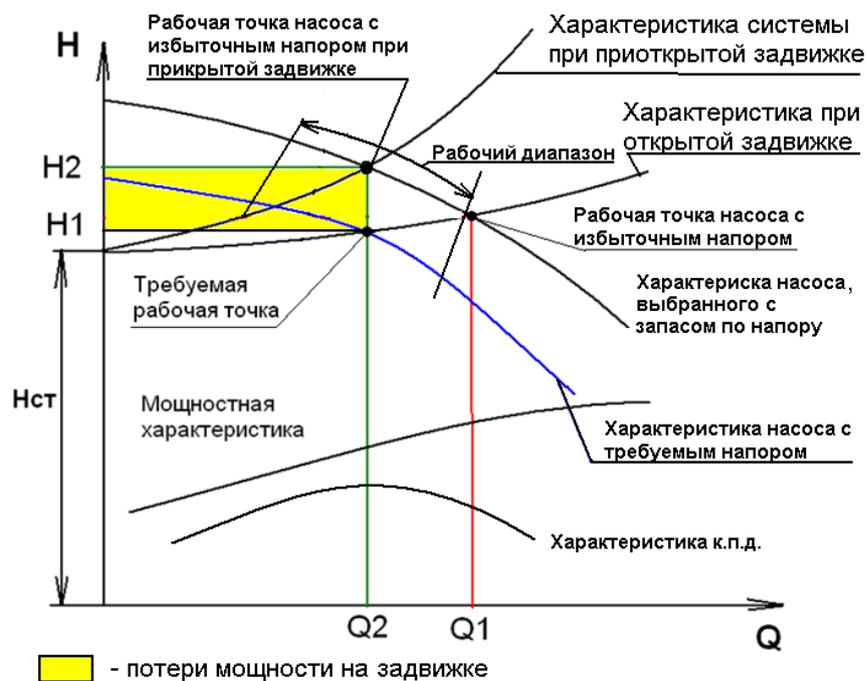
Рис. 2. Характеристики насосов с требуемым и избыточным напором.
